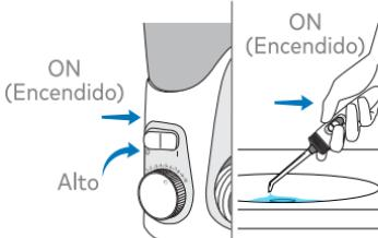
Gire la presión a alta; apunte el cabezal hacia el lavabo. Encienda el interruptor de encendido (ON) y el interruptor de agua (ON) hasta que el agua fluya. Apague la unidad (OFF).
