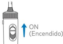
Con la energía apagada y el interruptor de agua en la posición APAGADO (OFF), coloque el cabezal en la boca. Encienda la unidad (ON). Encienda el interruptor de agua (ON).
